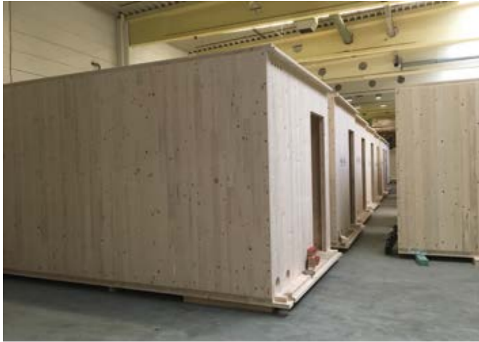
Modulfertigung im Werk ©MQ Real Estate
